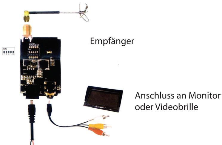
**\*Stellen Sie für Sender und Empfänger den gleichen Videokanal ein. Diesen können Sie wie gezeigt über die Kanalschalter einstellen\***
